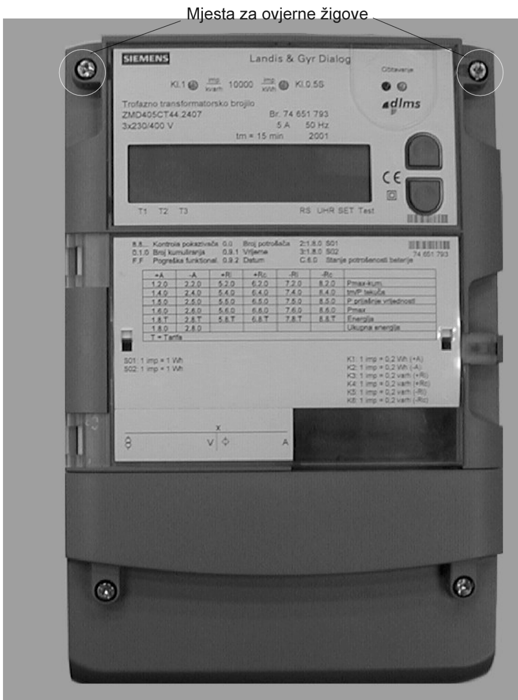
Slika 1. Izgled trofaznoga elektroničkog brojila tip ZMD 405 CT s označenim mjestima za žigosanje
